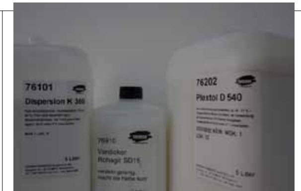
1. Компоненты клеящего вещества: Plextol K 360, Plextol D 540, Rohagit SD 15. Фото SRAL (@SRAL)
